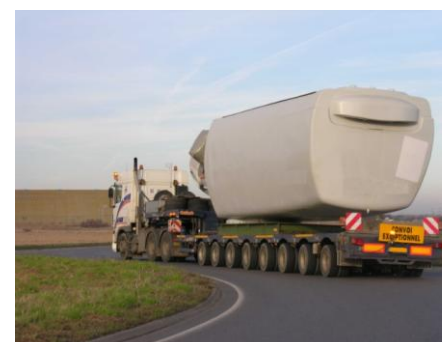
Transport de la nacelle
